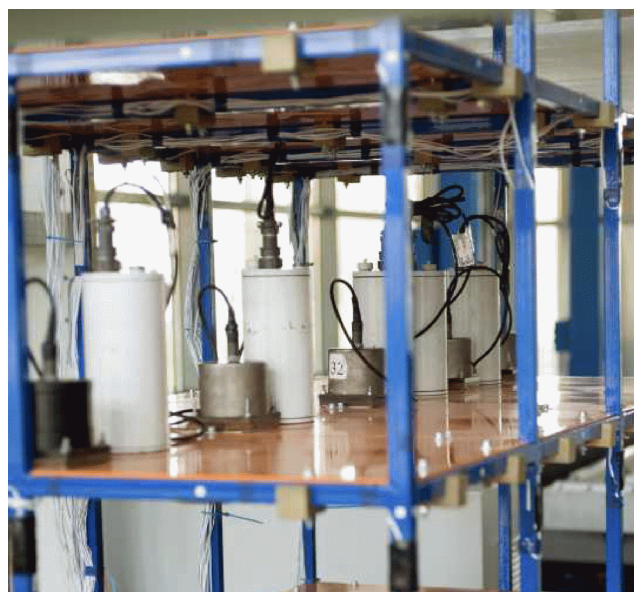
г) Сейсмоприемники и сейсморегистраторы на перекрытии
