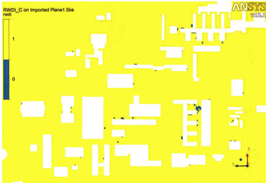
Рисунок 5.21 — Результаты для норм RWDI с учетом пульсационной составляющей для модели с окрестностью.
