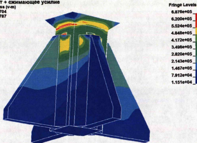
Рисунок 5.14. Катет 22 мм. Эквивал. истинные напряжения по Мизесу (кН/м 2 )
