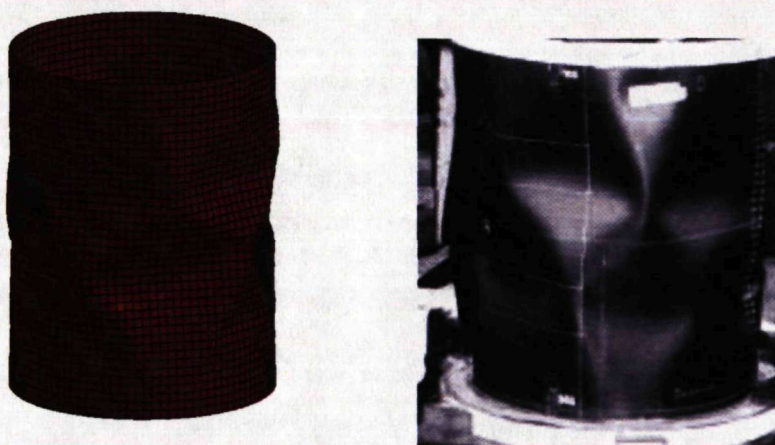
Рисунок 3.14. Полученная и опытная формы потери устойчивости оболочки
