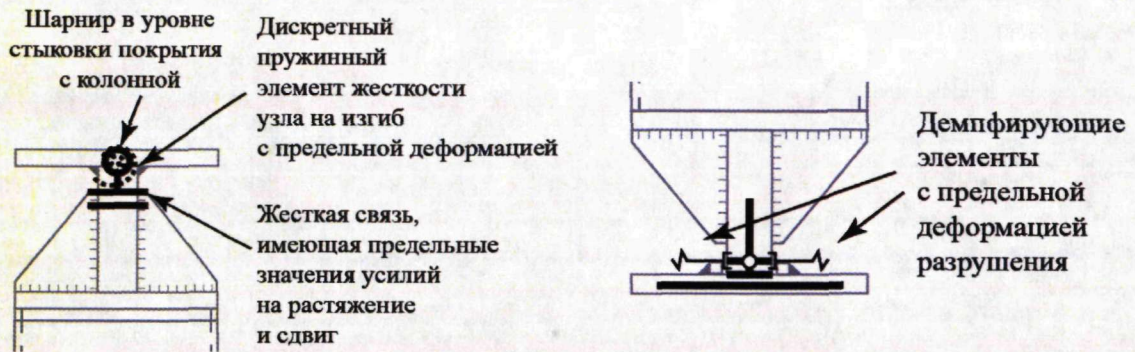
Рисунок 5.28. Моделирование схемы работы верхнего и нижнего узлов
